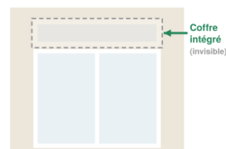
Coffre TUNNEL / menuisier
